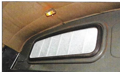
La vision sur l'arrière est assurée par une meurtrière un peu petite et généralement inutile lorsque le plateau est chargé. C'est ce qui explique la présence de deux rétroviseurs extérieurs.
