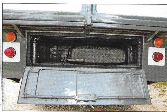
Sous le plateau de charge, un espace a été ménagé entre les passages de roues pour loger la roue de secours, le cric hydraulique et la manivelle.
