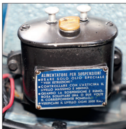
Le bocal d'huile typique de la suspension Lancia, à vérifier tous les 2 000 km, est accroché à l'aile gauche. L'un des boutons intègre la jauge de contrôle ; l'autre, soulevé, augmente la pression du circuit en durcissant l'amortissement. Le bouchon permet le remplissage.
