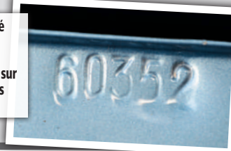
Plaque constructeur: placée sous la frappe, sur une traverse horizontale. L'Appia 3 e série est la toute première du modèle à troquer les anciens codes usine (C10 dans le cas des Appia 1 re et 2 e série) contre les 800 encore utilisés sur les Ypsilon d'aujourd'hui.
