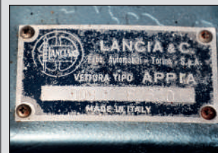
Plaque constructeur: placée sous la frappe, sur une traverse horizontale. L'Appia 3 e série est la toute première du modèle à troquer les anciens codes usine (C10 dans le cas des Appia 1 re et 2 e série) contre les 800 encore utilisés sur les Ypsilon d'aujourd'hui.
