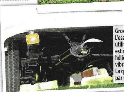
Gros plan sur le ressort de lames AR. L'essieu, renforcé, est spécifique aux utilitaires Appia. L'échappement est maintenu par deux ressorts hélicoïdaux qui absorbent les vibrations, notamment au démarrage. La queue de carpe chromée est fixée par un simple collier.
