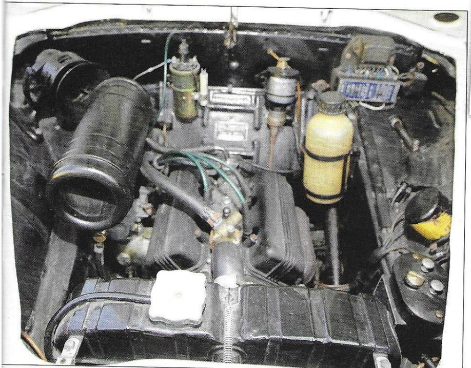
Le petit V4 des Appia, court et étroit, est spectaculaire. Devant le radiateur, on remarque la présence du ressort qui commande les volets thermostatiques permettant de doser l'air qui passe à travers les faisceaux. Le filtre à air (tout comme le carburateur) n'est pas situé au centre du V, très serré, mais décalé vers la droite (à gauche sur la photo).
