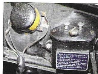
Sur la côte gauche, on trouve le réservoir hydraulique des amortisseurs, un élément typique des Appia et Aurelia.
