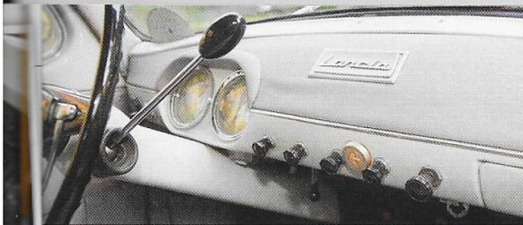
Au centre, les commandes des feux, de l'éclairage du tableau, du ventilateur de chauffage, des essuie-glaces et du lave-glace.
