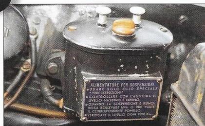
Le célèbre réservoir de liquide hydraulique pour les amortisseurs à colonne typiques des Lancia depuis la Lambda.
