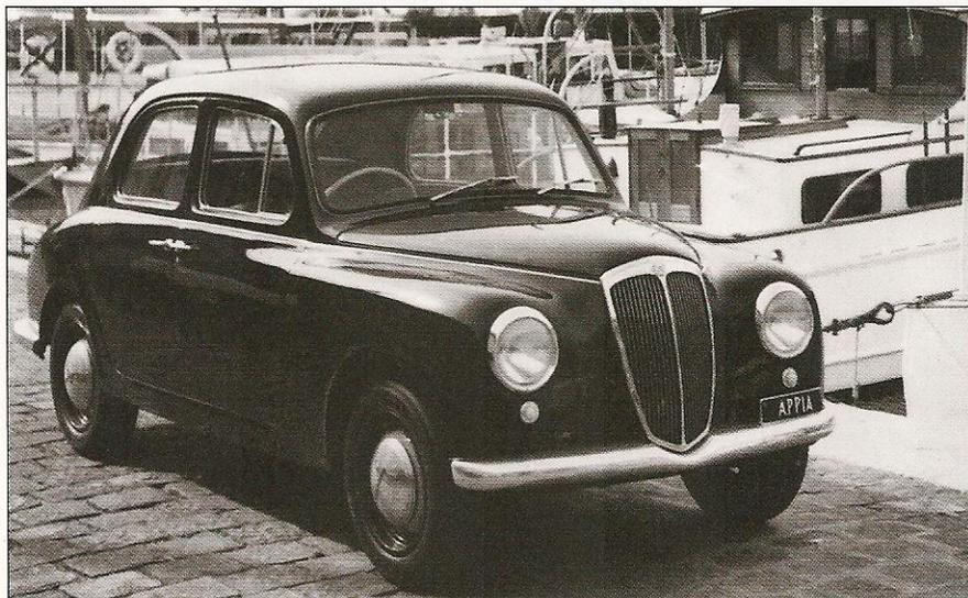
*In alto, la Lancia Appia 1<sup>a</sup> serie, costruita tra il 1953 e il 1955 in 20.025 esemplari. È dotata di un motore 4 cilindri a V con angolazione stretta di 1089 cm<sup>3</sup>, per un potenza di 38 Cv e una velocità massima di 120 km orari.*
