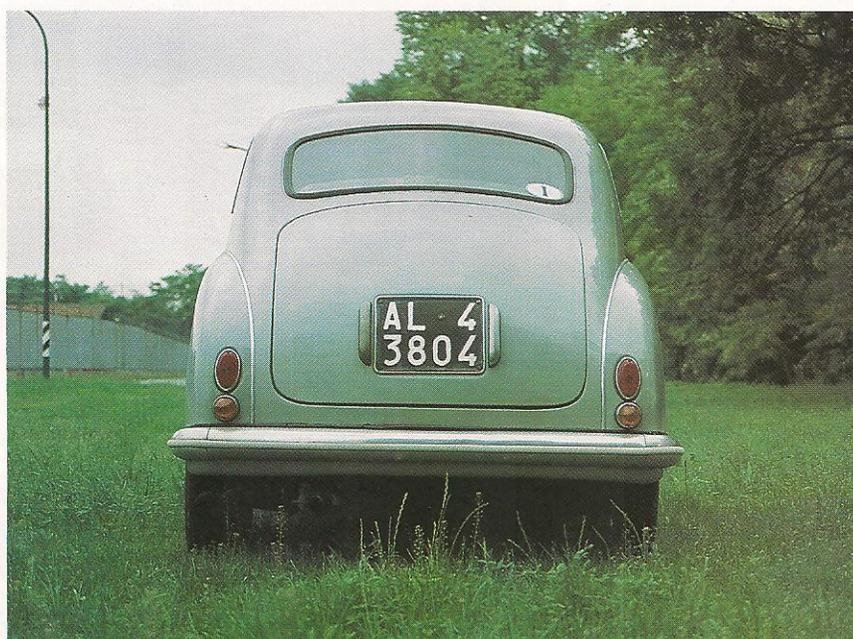
questi però non resistevano ai piccoli urti e facilmente si riempivano di ammaccature. Dopo alcune lamentele da parte dei clienti, la Casa pose rimedio all'inconveniente proteggendoli con una sottile striscia di gomma.
