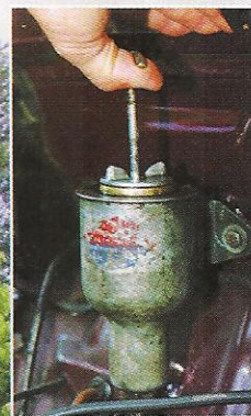
Pour augmenter la pression dans le circuit de freinage, on agit sur une pompe avant de partir !
