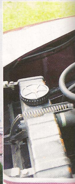
Pour augmenter la pression dans le circuit de freinage, on agit sur une pompe avant de partir !
